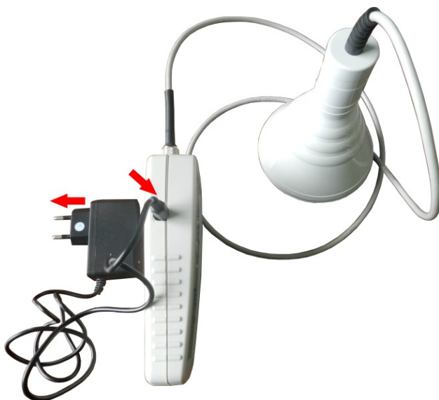
Рис.2 Подключение адаптера питания к аппарату
